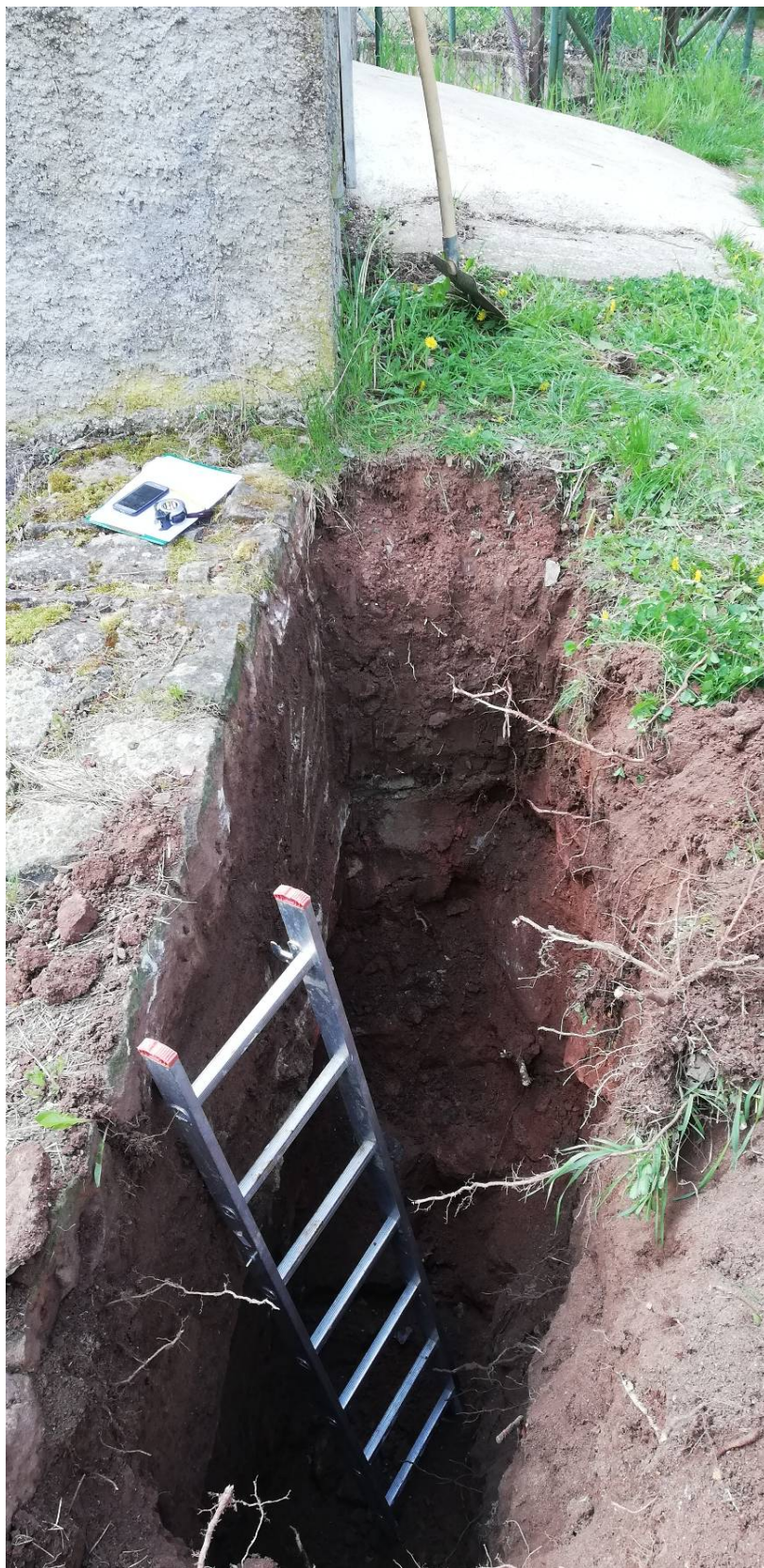
Levobřežní kopaná sonda s patrným kamenitým zásypem.
